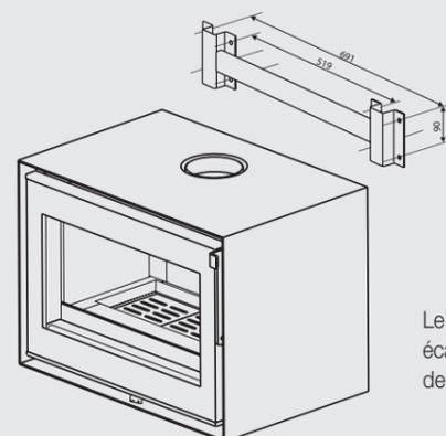
Le support fourni écarte l'arrière du poêle de 15 mm du mur.
