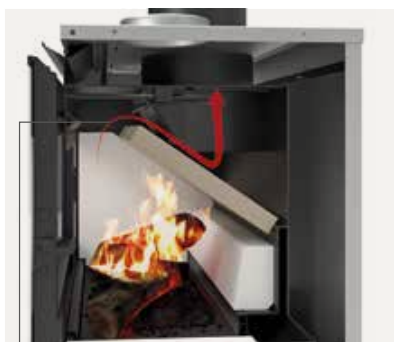
1- AVEC LA PORTE FERMÉE. Le clapet By-Pass est fermé et les fumées sont acheminées vers l'échangeur de chaleur.
