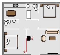
CANALISATION JUSQU'À 8 MÈTRES via une sortie arrière Ø80 (peut être exclue)
